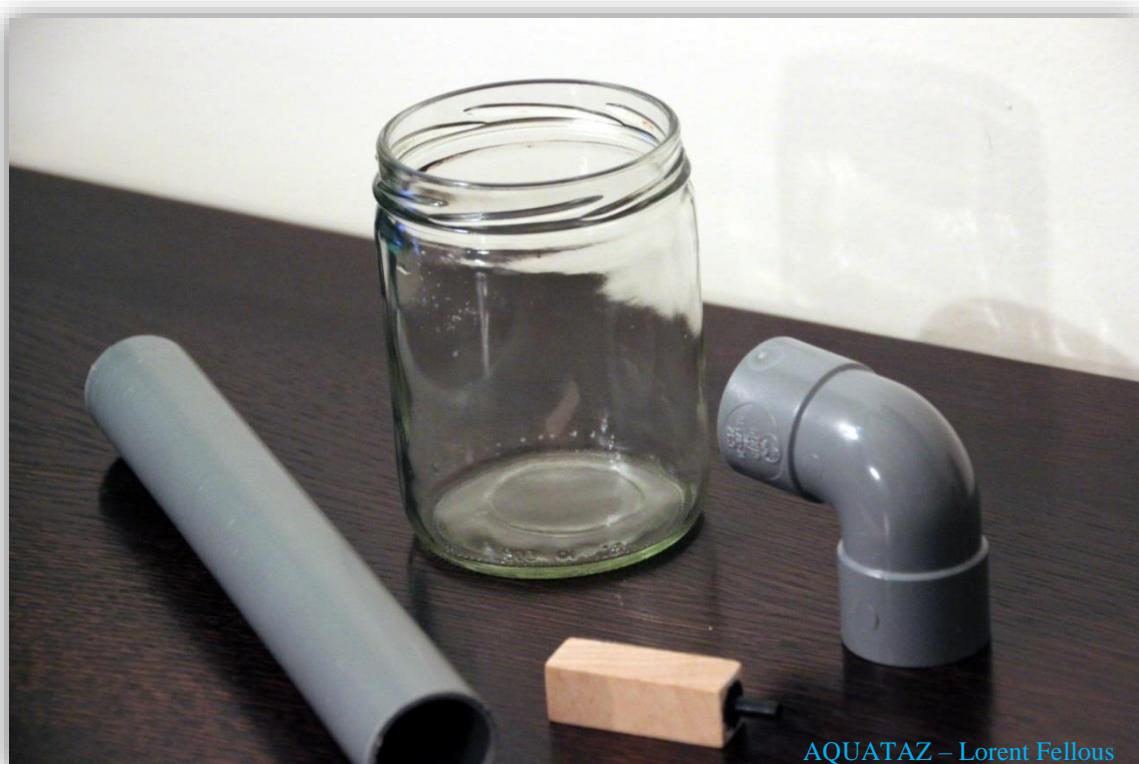
Percer le coude au niveau de l'angle afin d'y faire passer le tuyau à air
